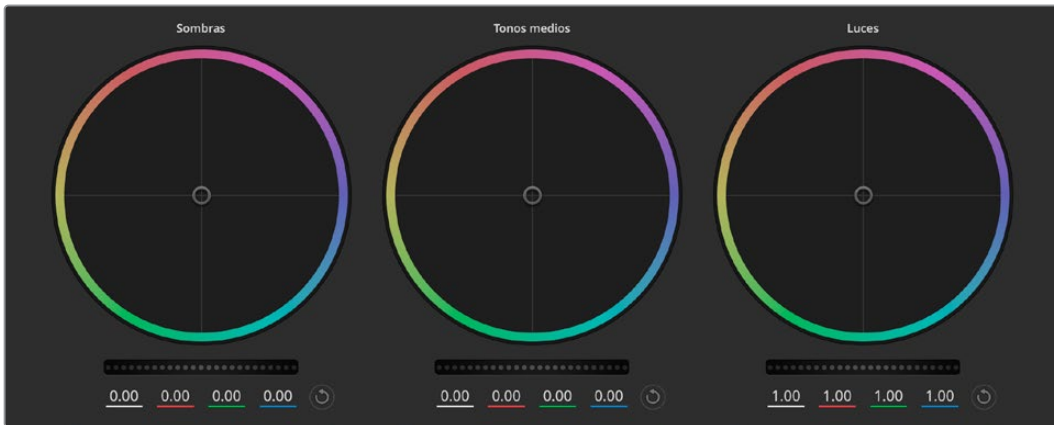
Círculos cromáticos para luces, tonos intermedios y sombras en el panel de etalonaje.
