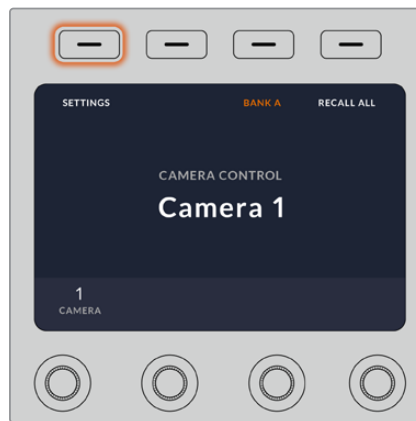
按下LCD屏幕主页上的“SETTINGS” (设置) 多功能按钮可进入摄影机控制面板所有设置
