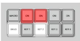
Steuerblock mit den Tasten „Next Transition“ vor dem Übergang
