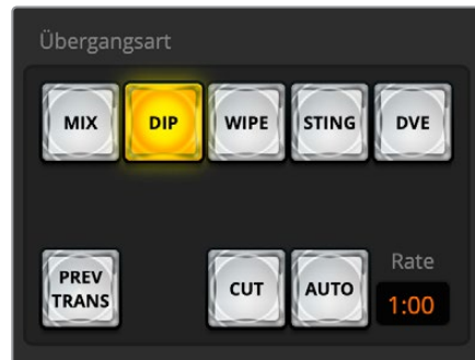
Die Übergangsschaltfläche AUTO gehört zur Tastengruppe der Übergangsarten
